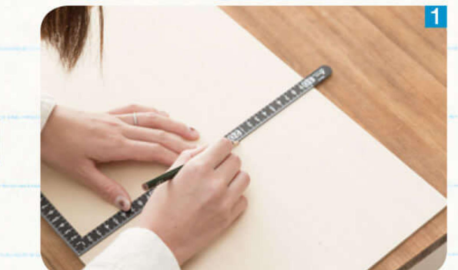
フレームの完成形のサイズ(300×255mm)に合わせて、土台となるベニヤ合板を採寸
