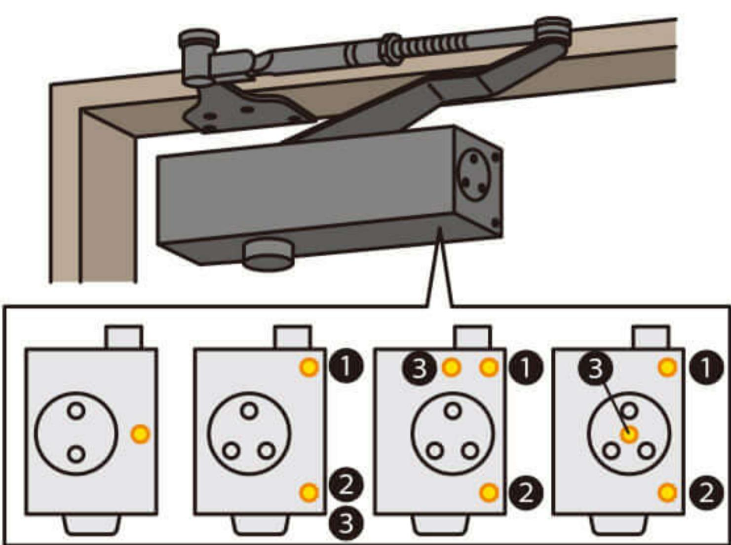
ドアクローザーの側面にあるネジをドライバーでまわすことで、ドアの開閉速度を調節が可能。時計まわりにまわすと遅くなり、反時計まわりにまわすと速くなります。①は全体的なドアの速さを、②はドアを枠におさめる速度を、③は閉じる寸前の速度を受け持っています。通常は①と②だけを調節すればOK。一度に1/10回転くらいまわして、動きの様子を見るのがコツです。
