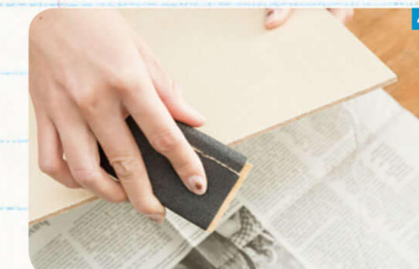
切断した材料の切断面を紙やすりできれいに整える。粗目のものの方が整えやすい
