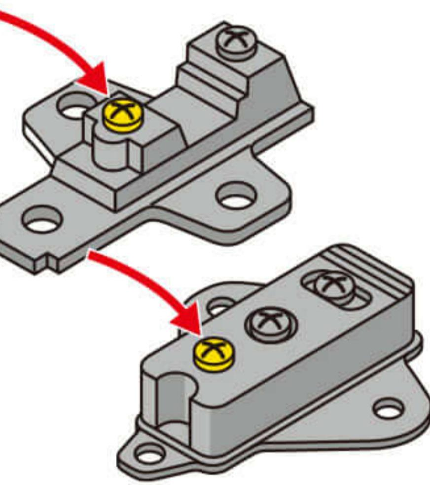
上図のようなタイプの場合、それぞれ黄色で示したネジで調節します。
